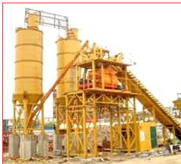
Hình 5: Phối cảnh minh họa dây chuyền sản xuất dự án Trạm trộn bê tông thương phẩm
